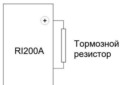
Рис. 12-3. Схема подключения тормозного резистора
