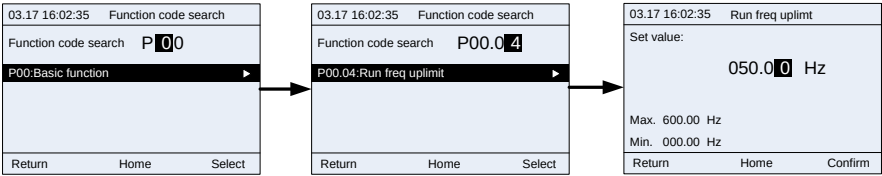
Рис. 8-56 Интерфейс поиска кода функции
