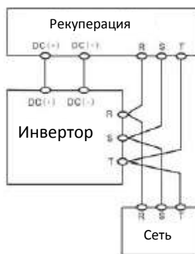
Рисунок 4.15. Электромонтаж цепи рекуперации
