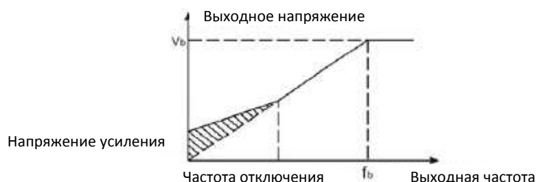
Рисунок 6.9. Характеристика для «ручного» усиления крутящего момента
