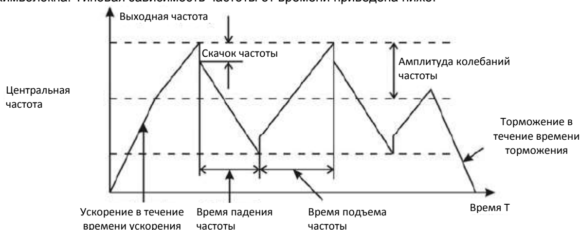
Рисунок 6.19. График управления двигателем с колебаниями частоты.
