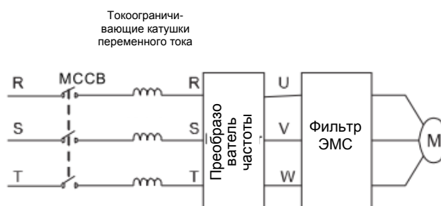
Рисунок 4.8 Электромонтаж цепи электродвигателя
