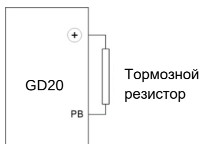
Рис. 12-3. Схема подключения тормозного резистора
